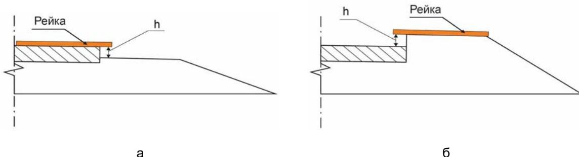
Рисунок 1 - Схема измерения величины занижения (возвышение) обочины и разделительной полосы:
