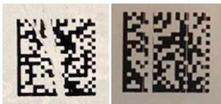
Нарушение целостности КМ*
